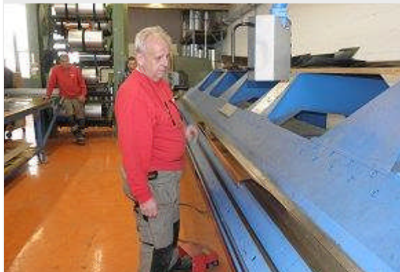
Rossi ist mit programmierbaren Abkantmaschinen eingerichtet, um bei Serien gleichbleibende Qualität garantieren zu können.
